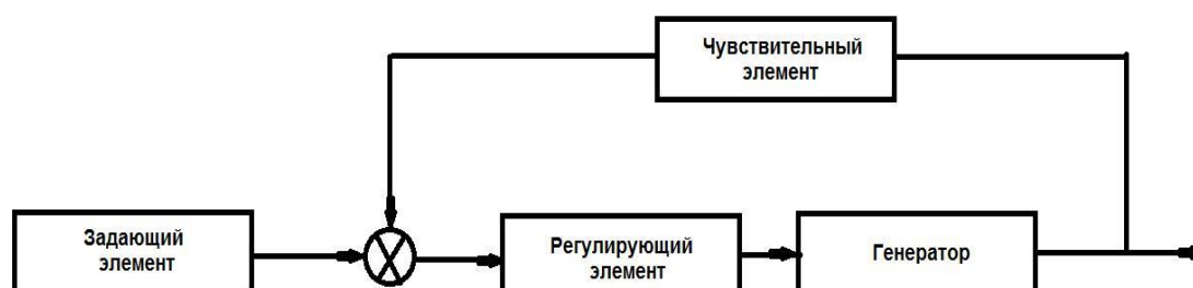
Рисунок 2.1- Функциональная схема системы автоматического регулирования напряжения в бортовой сети автомобиля
