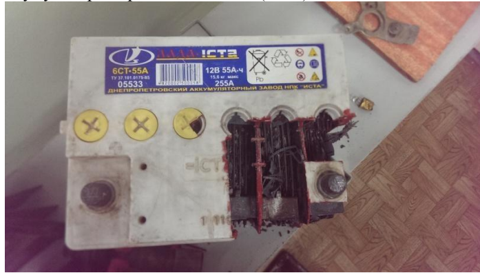
Рисунок 3.2-Аккумулятор Разрез АБ 6СТ 55А (Иста)
